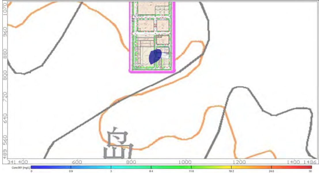
图8.3-27 调节池渗漏事故发生365天后含水层耗氧量浓度分布情况图
