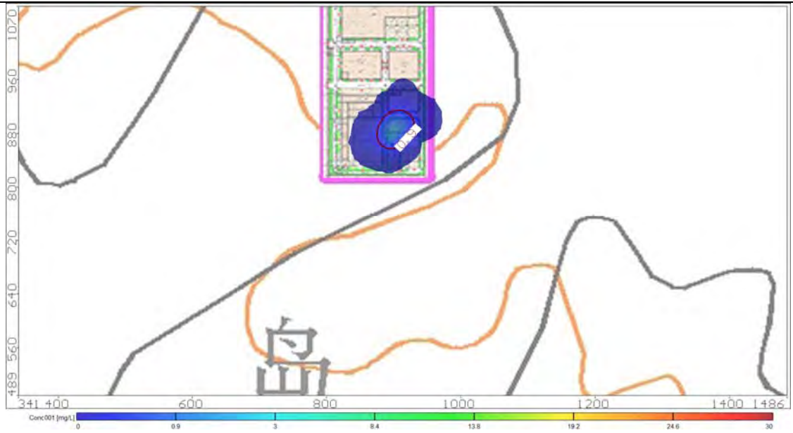
图 8.3-23 调节池渗漏事故发生 19 天后含水层耗氧量浓度分布情况图(贡献值刚好达标) (单位: mg/L; 阴影为贡献值检出限范围, 3.0 等值线为贡献值达标等值线, 0.9 等值线为叠加值达标等值线, 下同)
