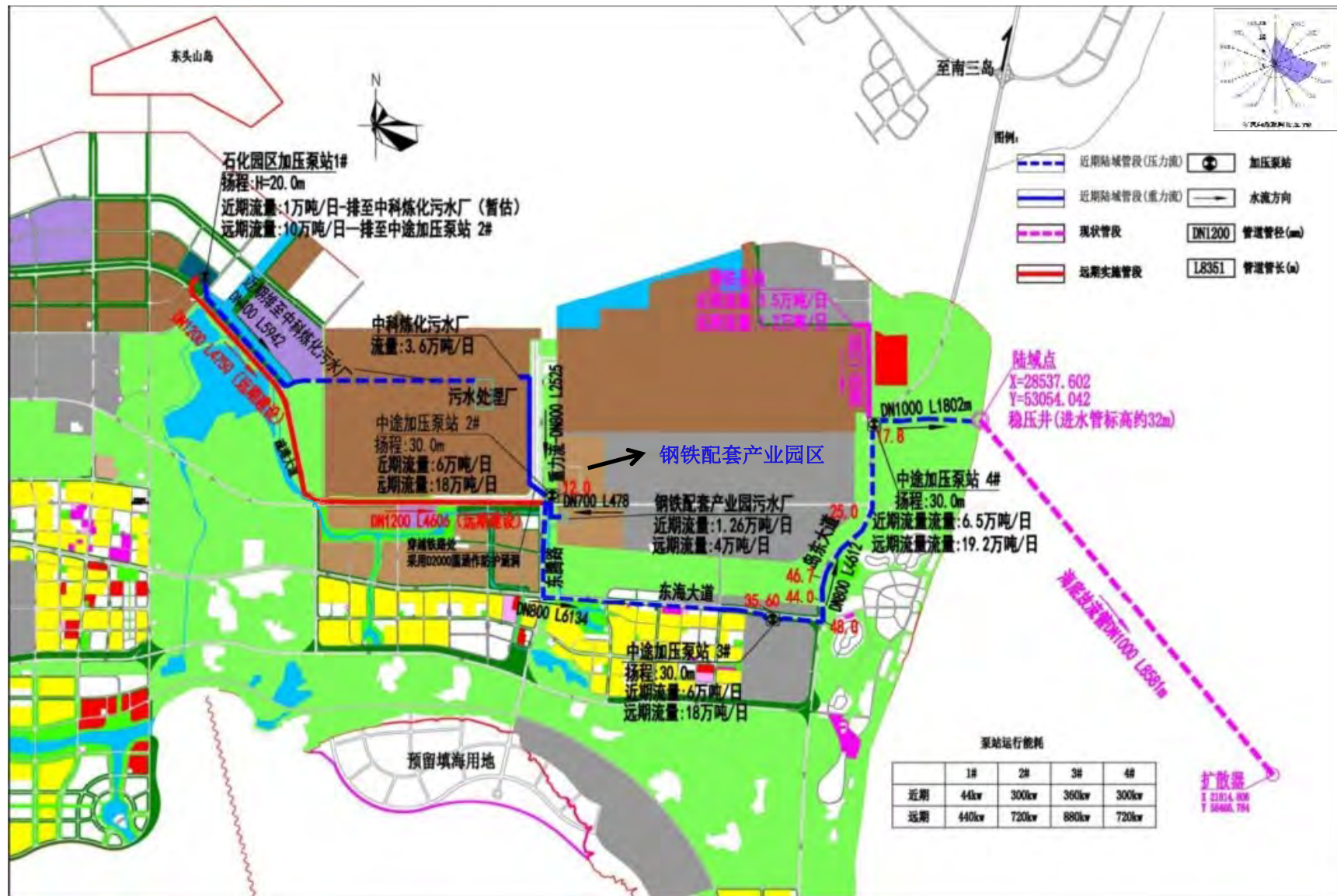
图 3.1-1 污水排放管道路由示意图
