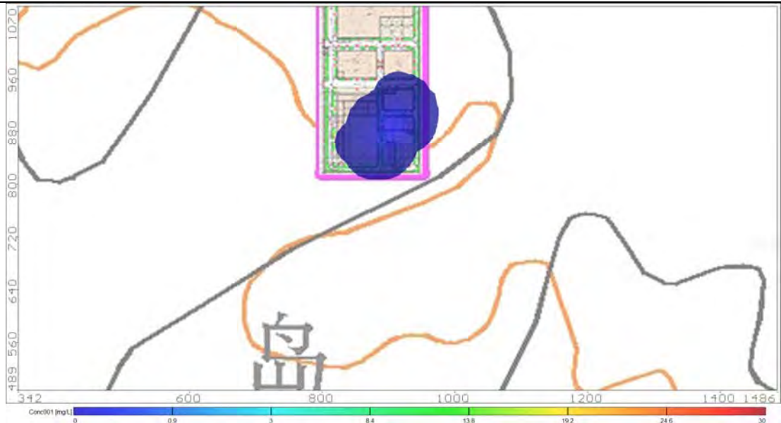
图 8.3-25 调节池渗漏事故发生 34 天后含水层耗氧量浓度分布情况图(叠加值刚好达标)
