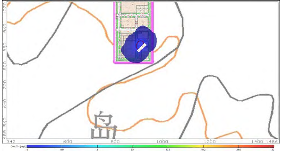
图 8.3-24 调节池渗漏事故发生 30 天后含水层耗氧量浓度分布情况图
