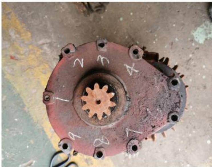
图 5: 变速齿轮箱固定螺丝分布情况
